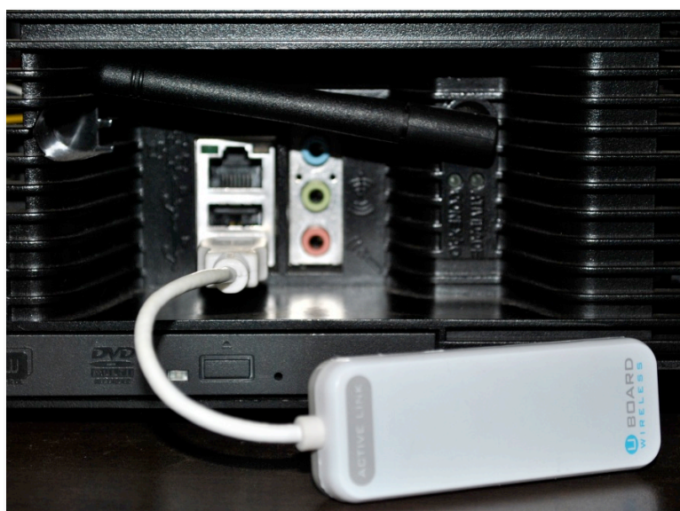
Figura 14 - Conexão do transmissor sem fio da Lousa Digital
