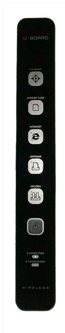
Figura 16 - Luz indicadora de conectividade do Sensor Station
